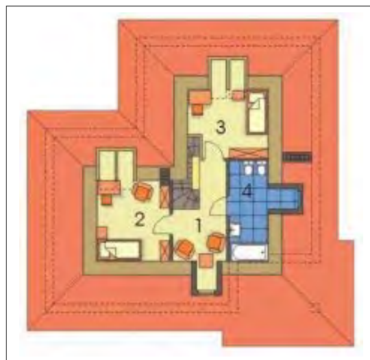
Rys. 4.3. Rzut poddasza wraz z oznaczeniem funkcji poszczególnych pomieszczeń.
