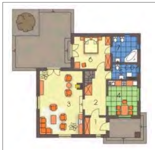
Rys. 4.2. Rzut parteru wraz z oznaczeniem funkcji poszczególnych pomieszczeń
