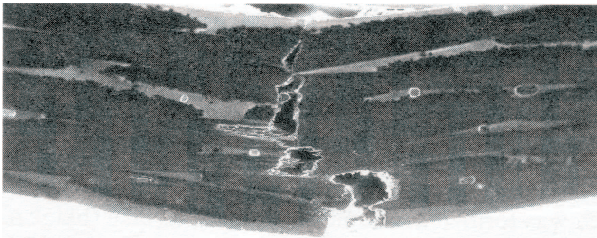
Rysunek 5.4: Zdjęcie przełomu struktury kompozytowej (matryca epoksydowa wzmocniona włóknami karbonowymi) z widoczną propagacją rysy poprzecznej
