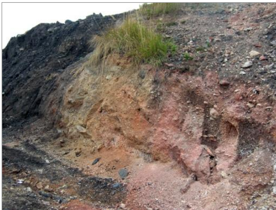
Fot. 3. Przepalony i nieprzepalony materiał zgromadzony na hałdzie (fot. A. Karczewska) Phot. 3. Blown and raw material gathered on the heap (photo A. Karczewska)
