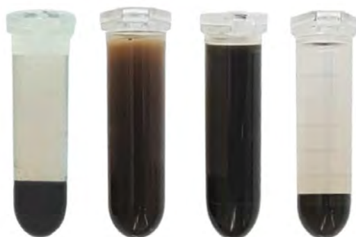
Rysunek 7.2: Zdjęcie (od lewej do prawej) przedstawia zawiesinę nanocząstek tlenku żelaza o średnim rozmiarze 12 nm w roztworze wodnym o pH = 7, 9, 11 oraz 13. Wraz ze wzrostem pH, kiedy oddalamy się od PZC, rośnie nadwyżka ładunku ujemnego na powierzchni nanocząstek, co zwiększa ich wzajemne odpychanie elektrostatyczne. Ponieważ, zgodnie ze wzorem 7.8, jednocześnie rośnie nadwyżka jonów hydroksylowych (tym samym rośnie siła jonowa), długość Debye'a maleje. Współzawodnictwo tych dwóch tendencji sprawia, że zawiesina koloidalna jest najbardziej stabilna w pobliżu pH = 11.
