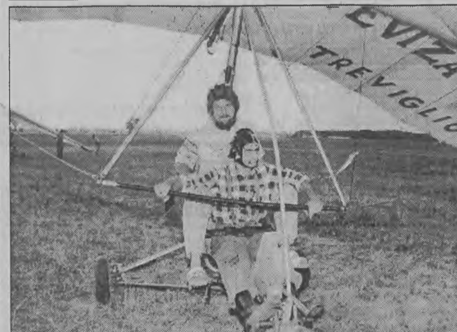
Łąki koło Świebodzina — instruktor sekcji łowiectwa Józef Parmonik za sterami wioskiej motosłupki. Może ona wnieść się na wysokość 1500 metrów. Maszyna ta jest dwuosobowa. Można jej używać również do prac agrolotniczych. Na miejscu pasażera nasz fotoreporter Marek Woźniak.
