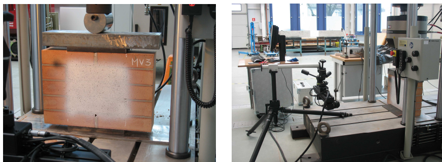
Fot. 2. Próbkę MV podczas testu ściskania Phot. 2. Specimen MV during the compressing test
