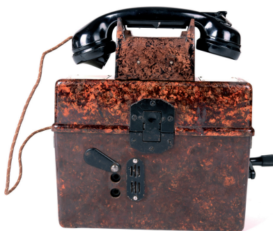
Telefon polowy model 33 (Feldfernsprecher 33) (Richard Bosse & Co., Berlin; Telefonbau Normalzeit GmbH, Frankfurt am Main, 1937 r.)
