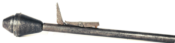
Bezodrzutowy granatnik przeciwpancerny Panzerfaust 60 lub 100 z nadkalibrową głowicą kumulacyjną
