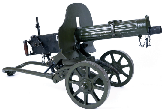
Ciężki karabin maszynowy Maxim wz. 1910, kal. 7,62 mm na podstawie kołowej Sokołowa. W WP w ZSRR używany w batalionowych kompaniach ckm-ów i kompanijnych plutonach ckm-ów
