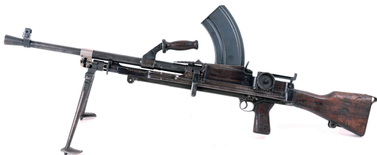
Ręczny karabin maszynowy Bren Mk 1, kal. 7,7 mm (Royal Small Arms Factory, II w. św.)
