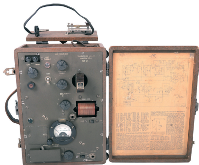
Walizkowe urządzenie nadawczo-odbiorcze AR-11 wykorzystywane m.in. przez członków francuskiego ruchu oporu (ARF Products, River Forest, USA, 1942-1945 r.)
