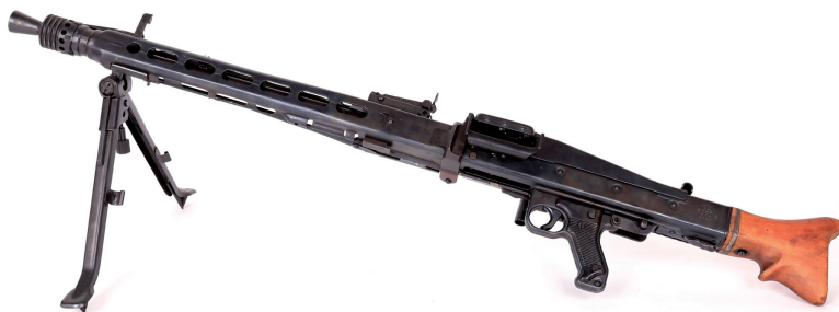
Uniwersalny karabin maszynowy MG-42, kal. 7,92 mm (Gustloff-Werke, Suhl in Thüringen, 1943 r.)
