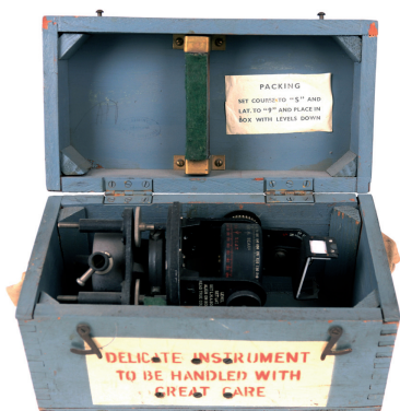
Astro Compass Mk 2. Służył do wyznaczenia pozycji samolotów. Stosowany głównie na samolotach transportowych i bombowych
