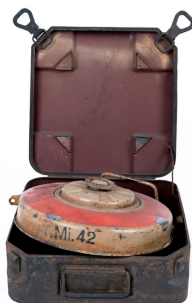
Metalowa skrzynia-nosidło z miną przeciwpancerną T.Mi. 42, w której umieszczano ładunek wybuchowy o masie 5,5 kg
