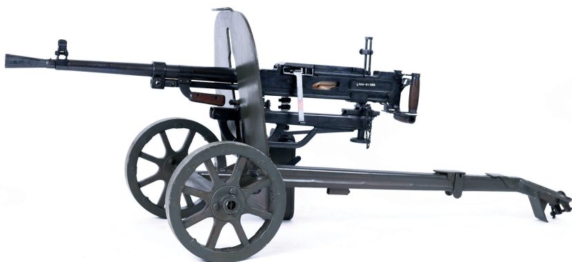
Ciężki karabin maszynowy Goriunowa wz. 1943 (SG-43), kal. 7,62 mm używany w niewielkich ilościach pod koniec II w. św.
