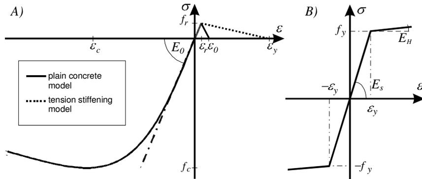
Fig. 3. Material models: A) concrete B) steel
